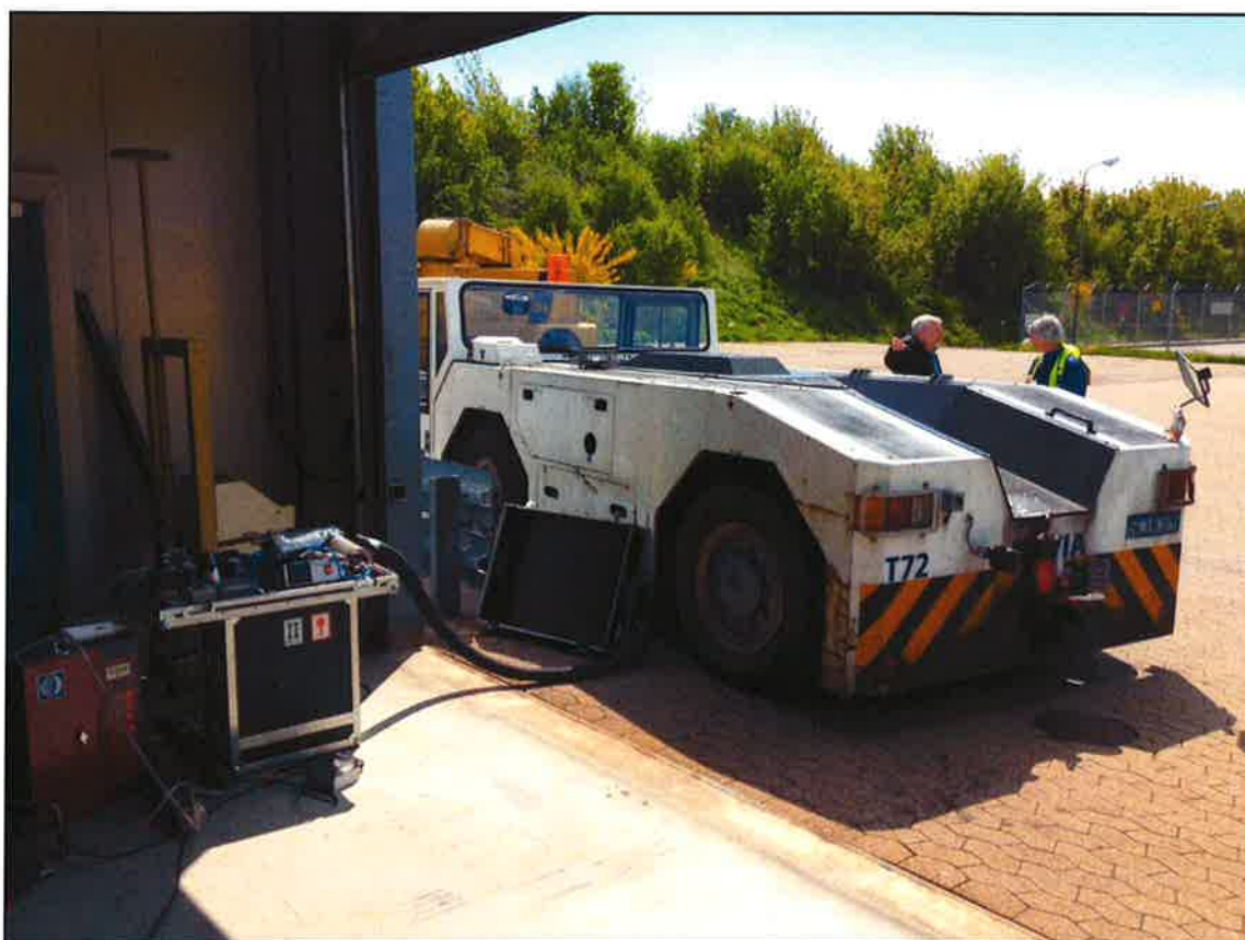
Figur 1. Push-back traktor samt måleudstyr (venstre side) ved CPH autoværksted
