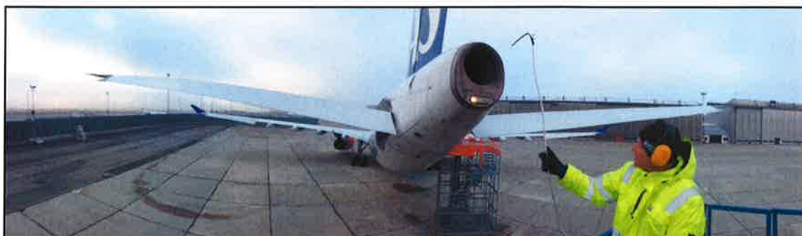
Figur 2. Udtagning af partikler med sample probe ved udstødningen fra APU'en på en Airbus A330.
